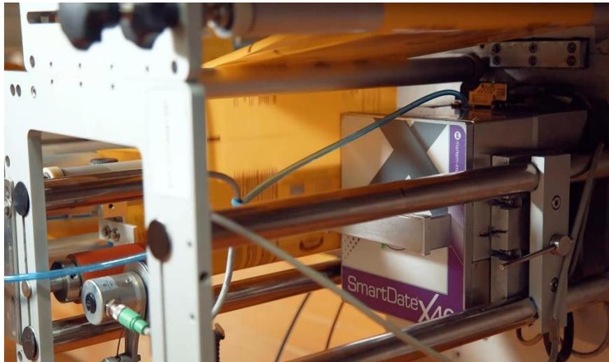
На фасовочном автомате установлен принтер, который наносит код маркировки.
